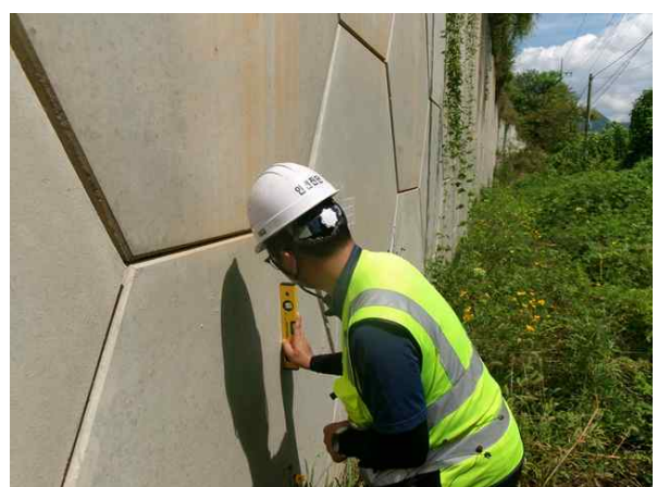
경사계를 이용한 경사도 측정
