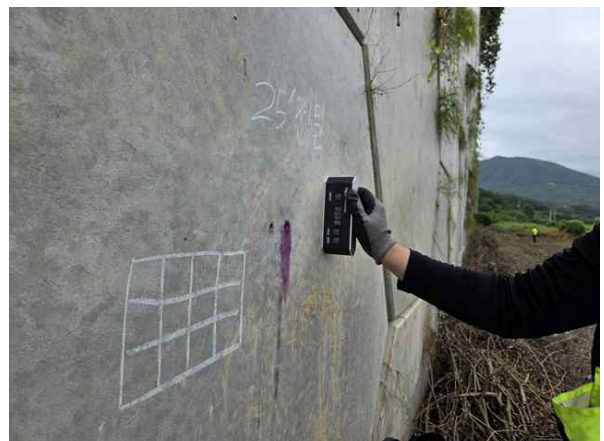
경사계를 이용한 경사도 측정
