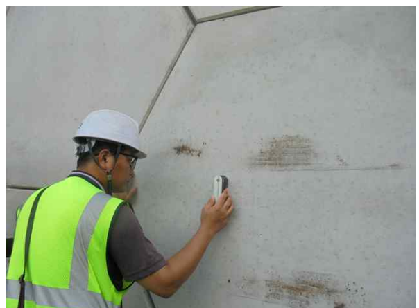
경사계를 이용한 경사도 측정
