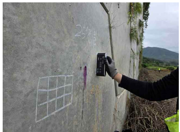
경사계를 이용한 경사도 측정
