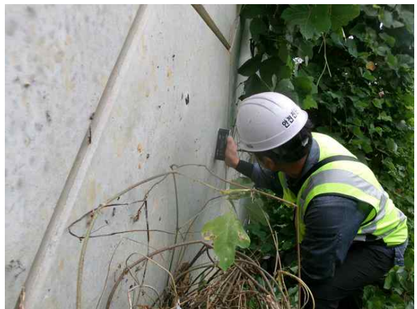
경사계를 이용한 경사도 측정
