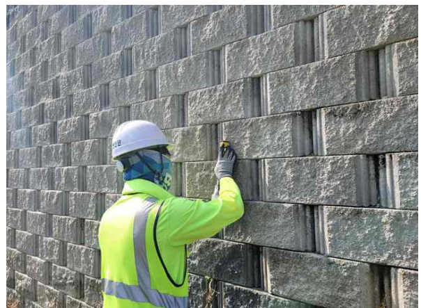
경사계를 이용한 경사도 측정
